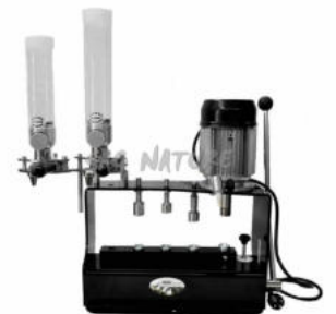
3301024 - PRESSA ROVER V-S2000 ORLATRICE MANUALE ELTRICA CON 4 STAZIONI COMPLETA DI DOSATORI, CALCABORRE, BOBINA, RIBASSATORE, CONIATORE ED INCISORE - GAEP
