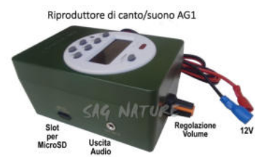
0206002 - RIPRODUTTORE CANTO Mod. AG1 CON TIMER INCORPORATO COMPLETO DI SCHEDA MICRO SD - 35 WATT - ALIMENTAZIONE 12V - BASSI CONSUMI (QUAGLIAIA)
